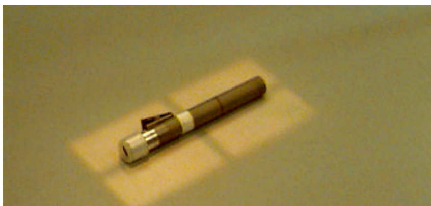
Figura 20 - Forma correta de posicionar a caneta dosimétrica
