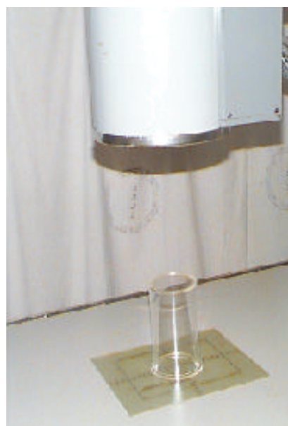
Figura 16B - Arranjo experimental para avaliação da coincidência de campo de luz e radiação .
