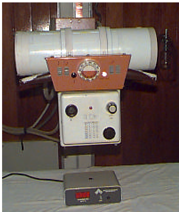
Figura 13B - Arranjo experimental para avaliação do tempo de exposição.
