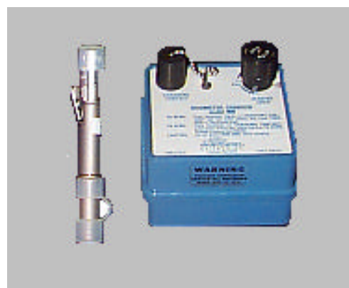
Figura 19 - Caneta dosimétrica e seu carregador
