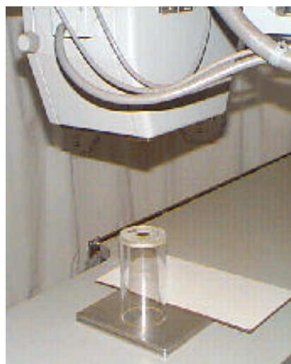
Figura 14B - Arranjo experimental para avaliação do tamanho do ponto focal
