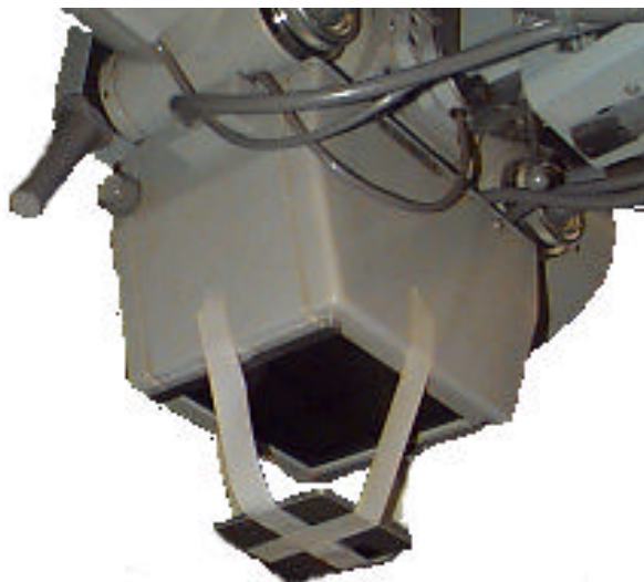
Figura 24 - Posicionamento das lâminas de alumínio para determinação da camada semi-redutora.
