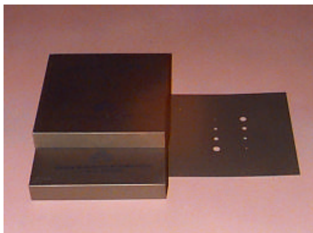
Figura 28 - Dispositivo de teste de resolução de baixo contraste.
